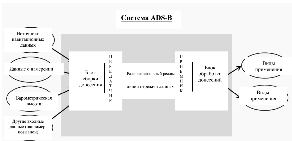
Рис. 1. Функциональная связь между ADS-B и видами применения наблюдения
