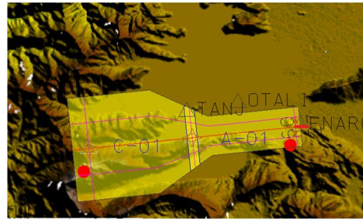
الرسم رقم ٢ - تخترق التضاريس منطقة حماية إجراءات الاقتراب وفق الأداء الملاحي المطلوب RNP APCH
