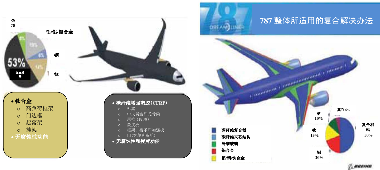
图 1: 空客 A350 和波音 787 设计中提高复合材料利用率的例子 [信息来源: 宇航工业协会国际协理理事会]。
