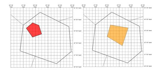
YUDD SIGMET 2 VALID 101200/101600 YUSO— YUDD SHANLON FIR/UIR SEV TURB FCST WI N4230 E02145 — N4315 E02115 — N4345 E02145 — N4330 E02215 — N4245 E02230 - N4230 E02145 FL250/370 INTSF FCST AT 1600Z WI N4145 E02315 — N4230 E02200 — N4330 E02215 — N4315 E02345 - N4145 E02315=
