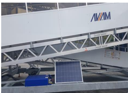
Escaleras solares en Punta Cana
