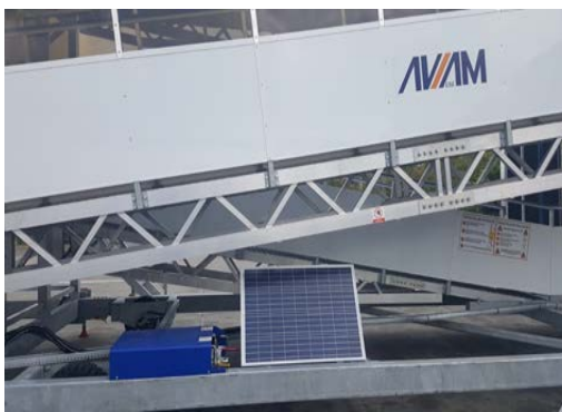
Escaleras solares en Punta Cana
