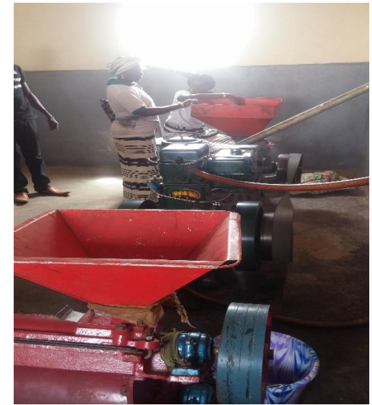
Huile de Jatropha utilisée pour le fonctionnement d'un moulin à Pabré
