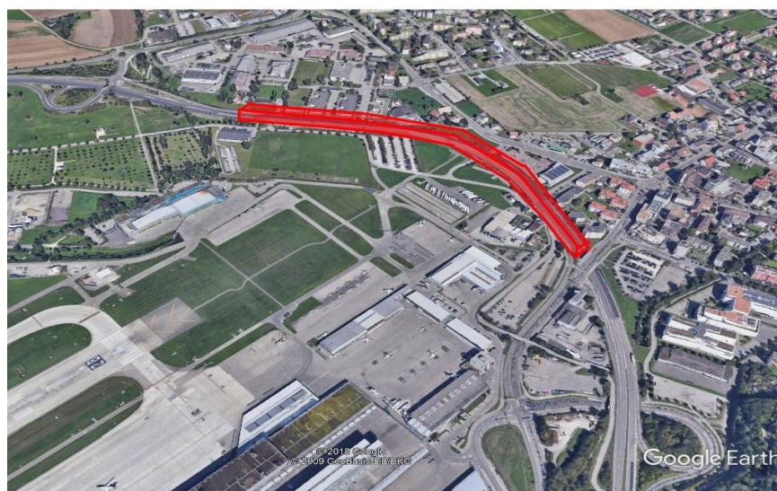
Figure A13: Les camions sur une autoroute sont des obstacles mobiles dans la zone d'approche d'une piste
