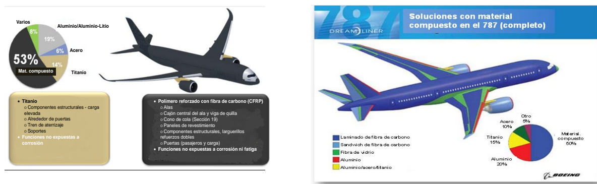
Figura 1: Ejemplos del incremento en la utilización de materiales compuestos en los diseños de Airbus A350 y Boeing 787 [Fuente: ICCAIA].
