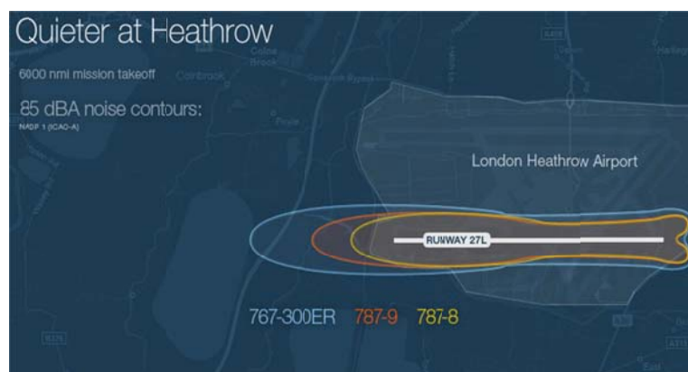
Comparaison de la courbe de bruit à l'aéroport Heathrow entre le Boeing 787 et le Boeing 767 2
