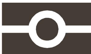
**Figure 1. Symbole indiquant la présence d'une puce électronique**
