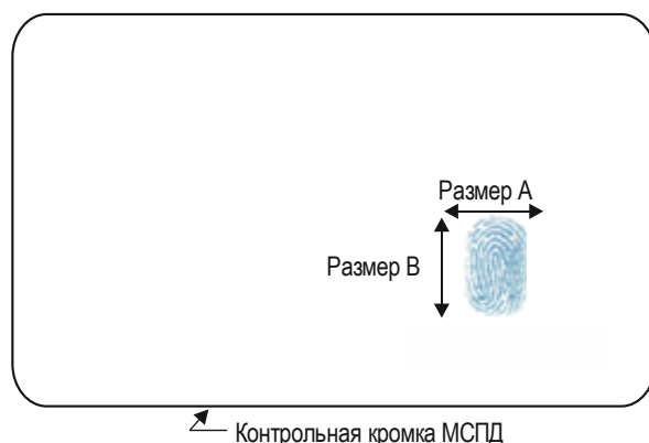
Рис. 3. Расположение отображаемого отпечатка одного пальца
