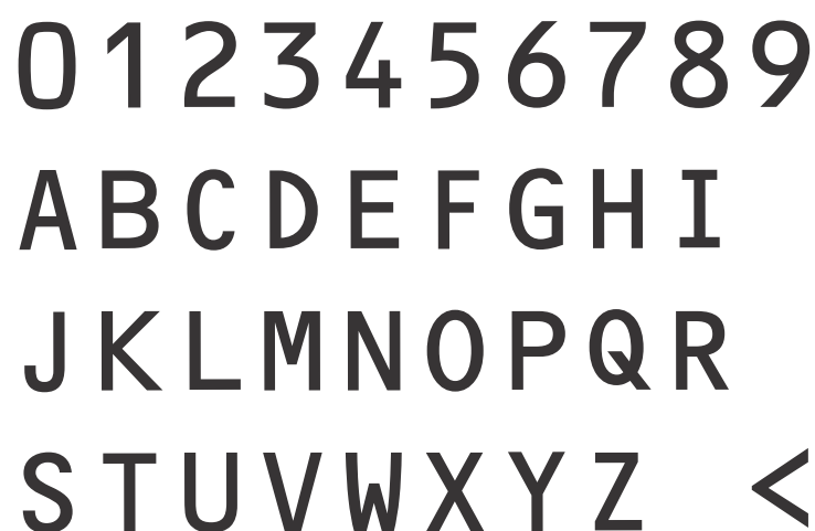
Figura 4. Subconjunto de caracteres OCR-B especificado en [ISO 1073-2] para utilizar en documentos de viaje de lectura mecánica
